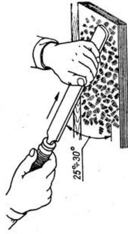
Rys. XIII-5. Sposób trzymania i prowadzenia skrobaka podczas skrobania
