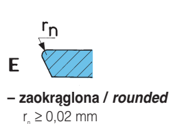
8. Postać krawędzi skrawającej Cutting edge condition
