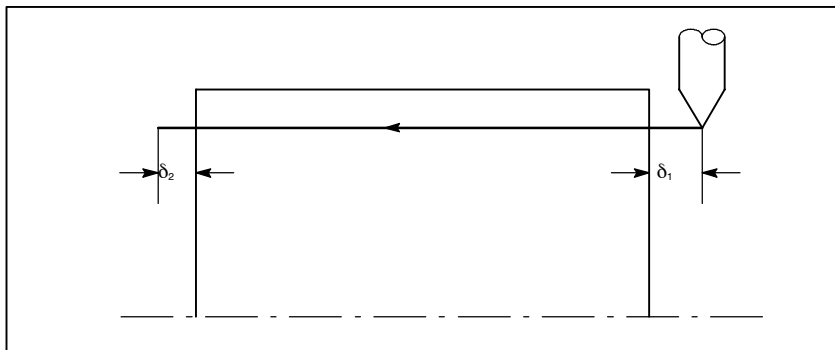
Rys. D.2 (a) Nieprawidłowo nagwintowany odcinek
