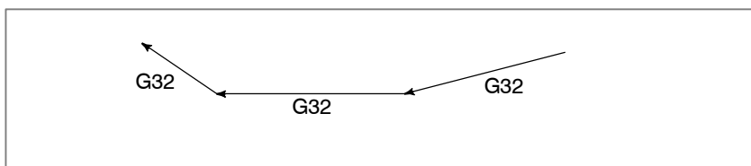
Rys. 4.11 Ciągłe nacinanie gwintu
