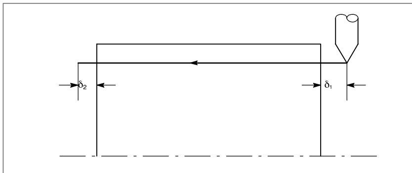
Rys. D.1 (a) Nieprawidłowe położenie gwintu
