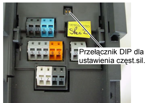
Rys. 3-3 Przełączniki DIP do wyboru częstotliwości silnika
