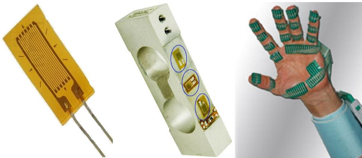
Rys. 5. Tensometryczne układy pomiarowe: a – pojedynczy tensometr foliowy, b – belka pomiarowa, c - system pomiarowy rozkładu ciśnienia chwytu dłoni.
