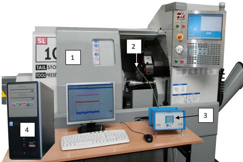
Rys. 2.11 Widok ogólny stanowiska badawczego do pomiaru składowych siły skrawania podczas toczenia.
