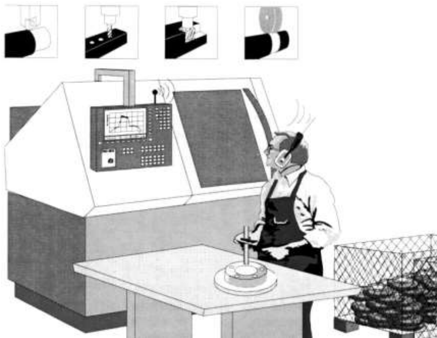
rys. 3.51. System nasłuchu procesu skrawania firmy Prometec [190].
