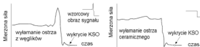
rys. 6.10. Wykrywanie KSO w oparciu o rozpoznawanie obrazu [205, 228].
