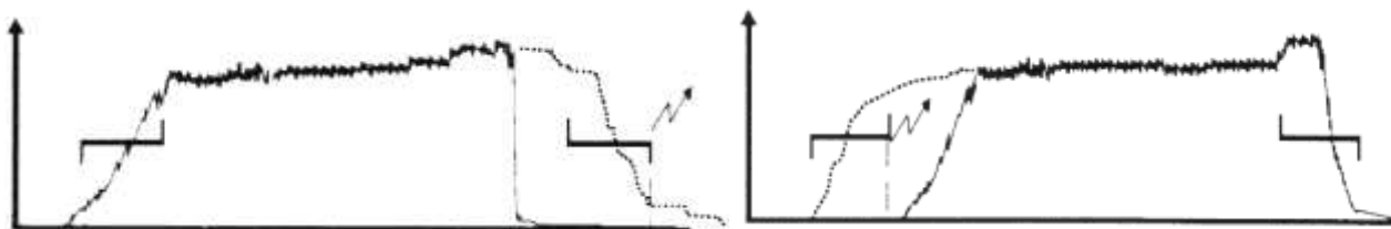
rys. 6.22. Wykrywanie nieprawidłowości procesu obróbki przy pomocy granic typu „wzrost przez” i „spadek przez” wg [14].
