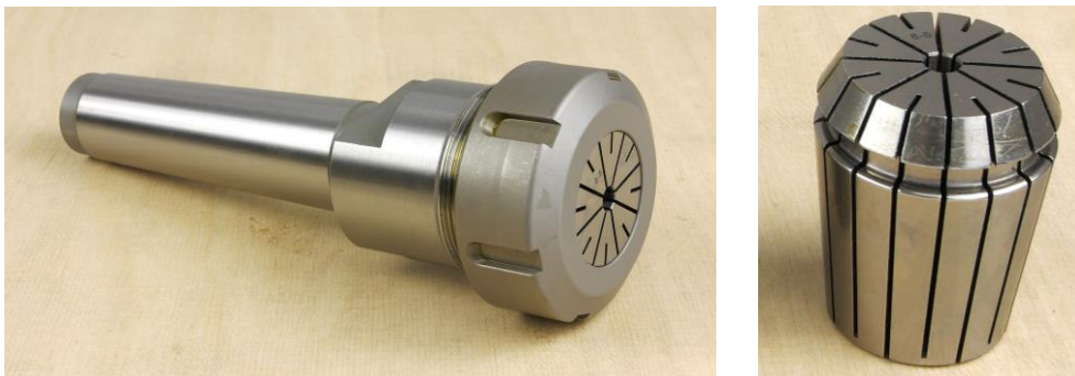
Fig. 2 Oprawka zaciskowa z chwytem Morse'a do tulejek ER i tulejka zaciskowa ER
