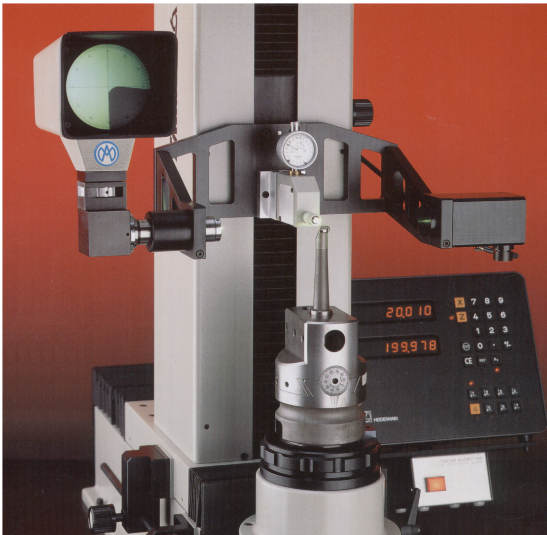
Rys. 34. Urządzenie optyczne do nastawiania i pomiarów narzędzi poza obrabiarką (f. Trimos)
