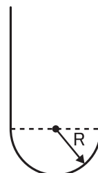
Płytką narzędzia bez linii prostej Tool tip without straight line
