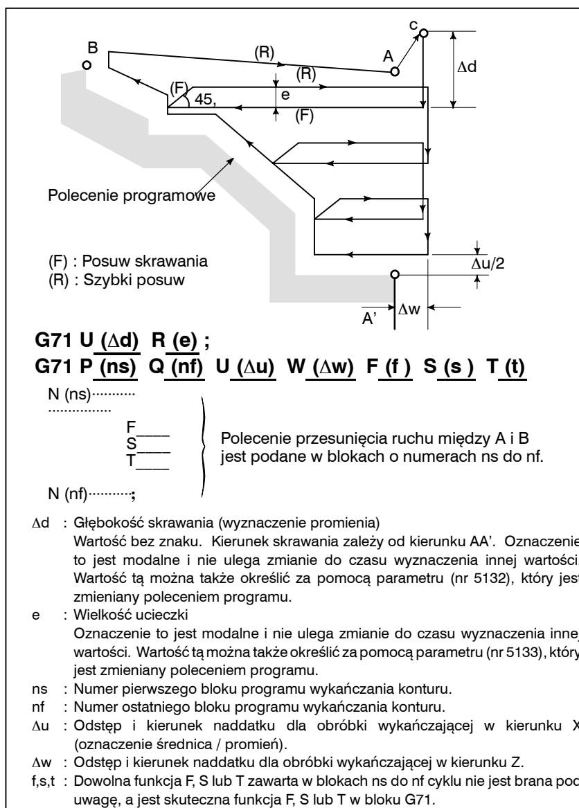
Rys. 13.2.1 (a) Tor skrawania podczas usuwania nadatku materiału przy toczeniu (Typ I)
