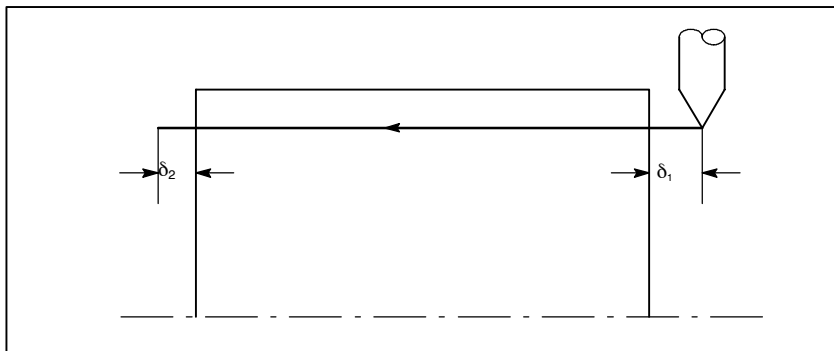
Rys. D.2 Niewłaściwie nagwintowana część
