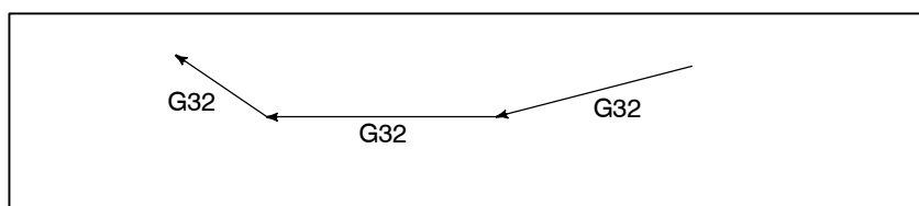
Rys. 4.9 Ciągłe nacinanie gwintu
