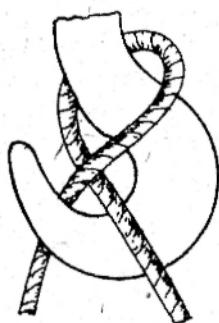
Rys. 1. Zaczepienie liny na haku.
