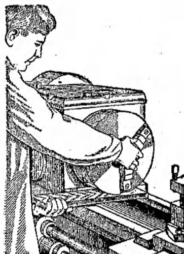
Rys. 52. Nakręcanie uchwyty samocentrującego na wrzeciono.
