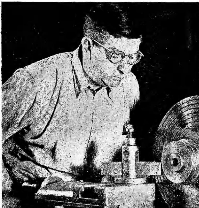
Rys. 58. Lekkie okulary z bocznymi osłonkami, używane przy pracy na tokarce.
