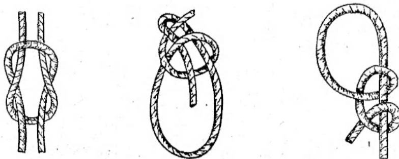
Ryc. 2. a. Węzeł krzyżowy. b. Pętla podwójna. c. Martwa pętla
