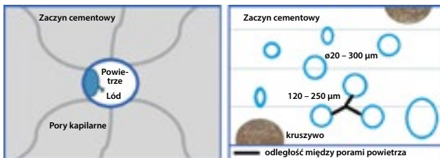
Rys. 6.18. Schemat napowietrzenia betonu i rozmieszczenie porów
