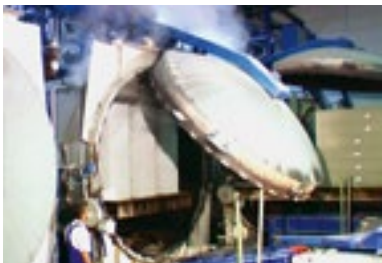
Rys. 6.70. Autoklaw wysokociśnieniowy do produkcji wyrobów z ABK
