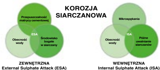
Rys. 6.61. Rodzaje i przyczyny korozji siarczanowej
