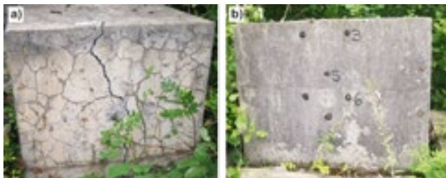
Rys. 6.63. Reakcja ASR, a) przykład destrukcji betonu zwykłego, b) beton z dodatkiem popiołu lotnego
