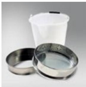
Rys. 6.47. Badanie odporności na segregację metodą sitową
