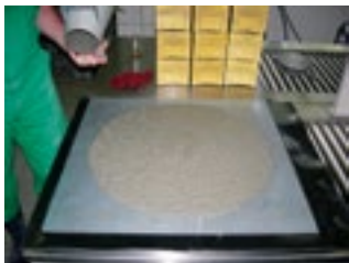
Rys. 6.64. Badanie konsystencji mieszanki samozagęszczalnej – pomiar rozplywu stożka
