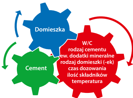
Rys. 6.21. Czynniki decydujące o kompatybilności domieszek chemicznych
