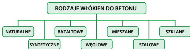
Rys. 6.31. Klasyfikacja włókien stosowanych do betonu
