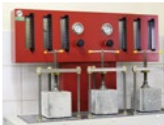
Rys. 6.50. Schemat badania głębokości penetracji wody w betonie oraz widok aparatury badawczej
