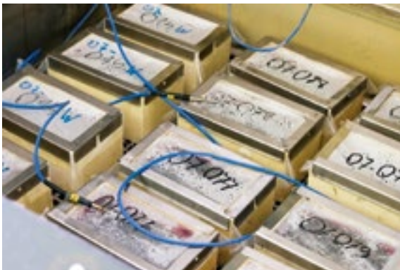
Rys. 6.53. Badanie mrozoodporności w obecności soli odladzających
