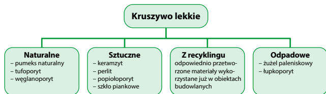
Rys. 4.8. Podział kruszyw lekkich wg normy PN-EN 13055-1:2003 wraz z przykładami
