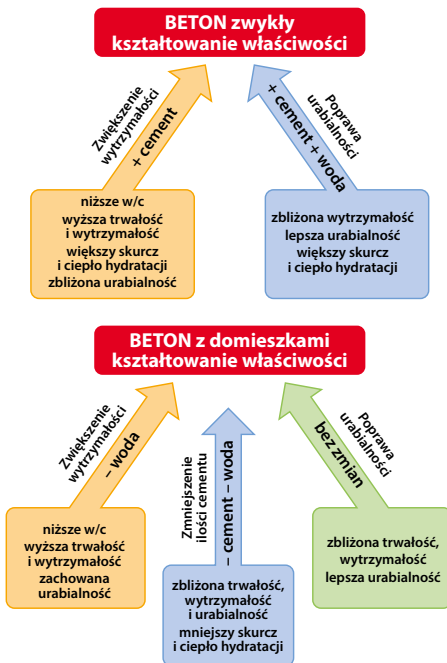
Rys. 6.17. Możliwości kształtowania właściwości betonu z domieszkami upłynniającymi (superpalastyfikatorami).
