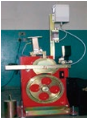
Maszyna do badania polerowania PSV
