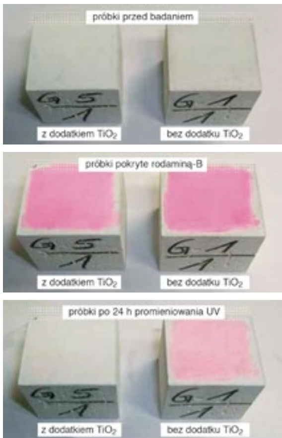
Rys. 6.74. Właściwości fotokatalityczne cementu TioCem®
