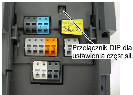
Rys. 3-3 Przełączniki DIP do wyboru częstotliwości silnika
