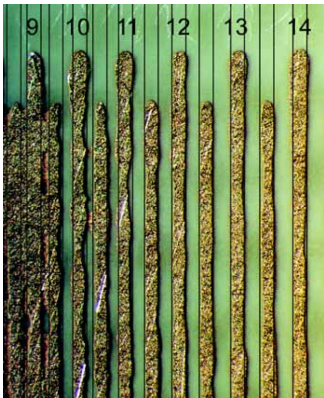
Fot. 18. Ścieżki 6 mils w zmiennych odstępach. Liczby oznaczają odległość w milsach pomiędzy osią ścieżki centralnej a osiami jej najbliższych sąsiadów. Zachowanie ok. 6 mils separacji wystarcza do wyeliminowania zwarć
