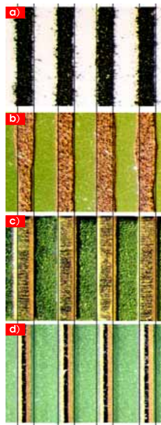
Fot. 16. Ścieżki 6 mil w różnych wykonaniach: wydruk 600 dpi na papierze kredowym (a); termotransfer z papieru kredowego (b); technologia profesjonalna z maską fotopolimerową (c); technologia profesjonalna z maską metaliczną Sn-Pb (d). Wykonania profesjonalne zapewniają znacznie lepszą równomierność ścieżek niż metoda termotransferowa, ale nie bez niespodzianek - w ostatniej próbce (maska SnPb) ze ścieżek o projektowanej szerokości 6 mil zostało zaledwie ok. 2 mil
