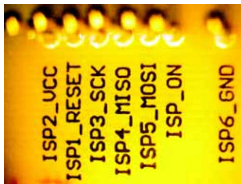
Fot. 23. Złącze ISP na podstawie uruchomieniowej opisane (warstwa Top Overlay) metodą termotransferową z oderwaniem papieru na gorąco. Wzdłuż górnej krawędzi widoczny zarys sprężystych szpilek testowych produkowanych przez Q&A rozmieszczonych w rastrze 100 mils. Całkowita wysokość znaków wynosi 60 mils
