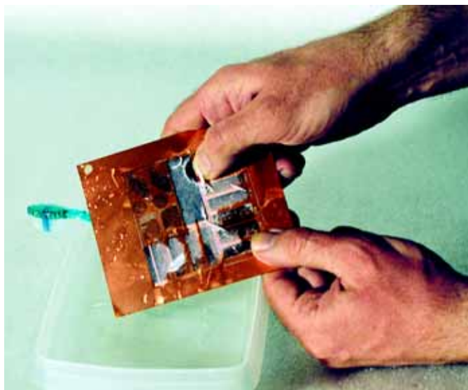
Fot. 13. Do usuwania resztek powłoki kredowej można użyć szczoteczki do zębów, a najlepiej - opuszka własnego palca. Prawidłowo nałożony toner mocno przylega do miedzi i wytrzymuje bez uszczerbku nawet energiczne pocieranie
