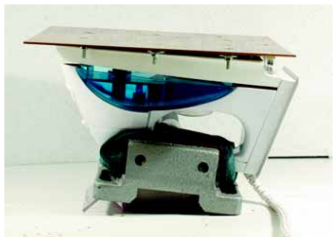
Fot. 7. Wbrew potocznej nazwie metody, żelazko służy nie do prasowania, a jako gorący stolik podgrzewający od spodu płytkę laminatu. Optymalna temperatura płyty wynosi ok. 155...160°C
