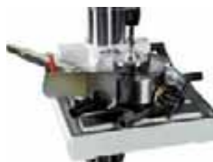
Jednostka główna z uchwytem 3- szczękowym 200 mm (nr 22385 050) i osprzętem specjalnym
