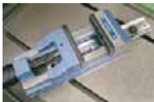
Mocowanie za pomocą szyny prowadzącej
