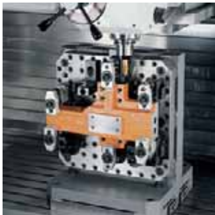
Płyta wymienna umocowana na kątowniku podstawy
