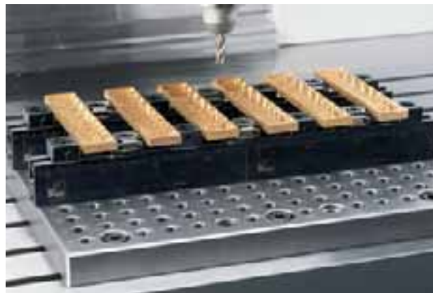
Płyta modułowa w połączeniu z wielokrotnym systemem mocowania
