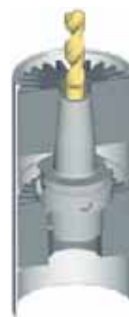
Uchwyty zaciskowe w adapterze chłodzącym
