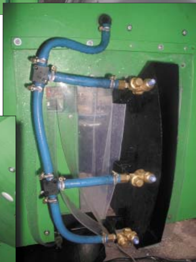
Wnętrze tunelu. Dolny system nadmuchu i oprysku cieczy roboczej.
