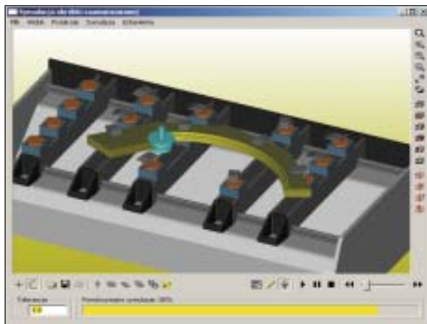
Produkcja okien łukowych. Symulacja obróbki sprawdza poprawność rozmieszczenia uchwyty...
