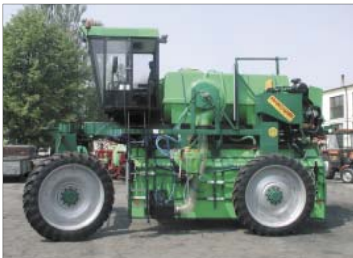
Dla poprawy warunków pracy operatora przewidziano kabinę z ogrzewaniem i klimatyzacją. Widoczne resorowanie fotela operatora (powyżej).
