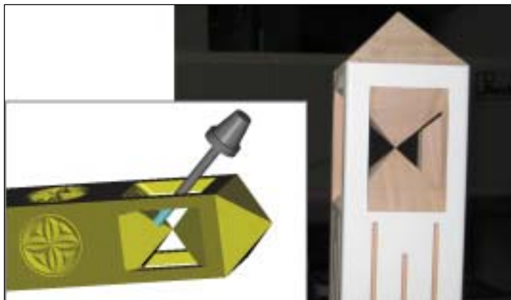
Przykłady zastosowania AlphaCAM: Obróbka 5-osiowa indeksowana słupka. Obróbka realizowana w czterech zamocowaniach...
