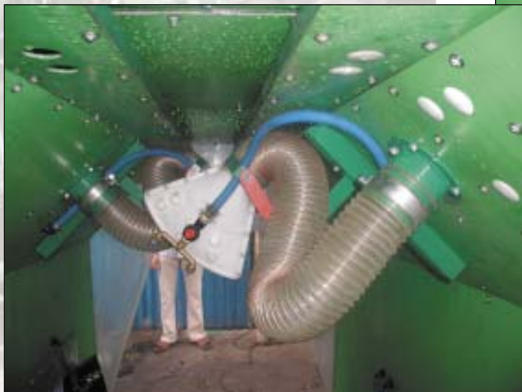
Wnętrze tunelu. Górny system nadmuchu i oprysku cieczy roboczej.
