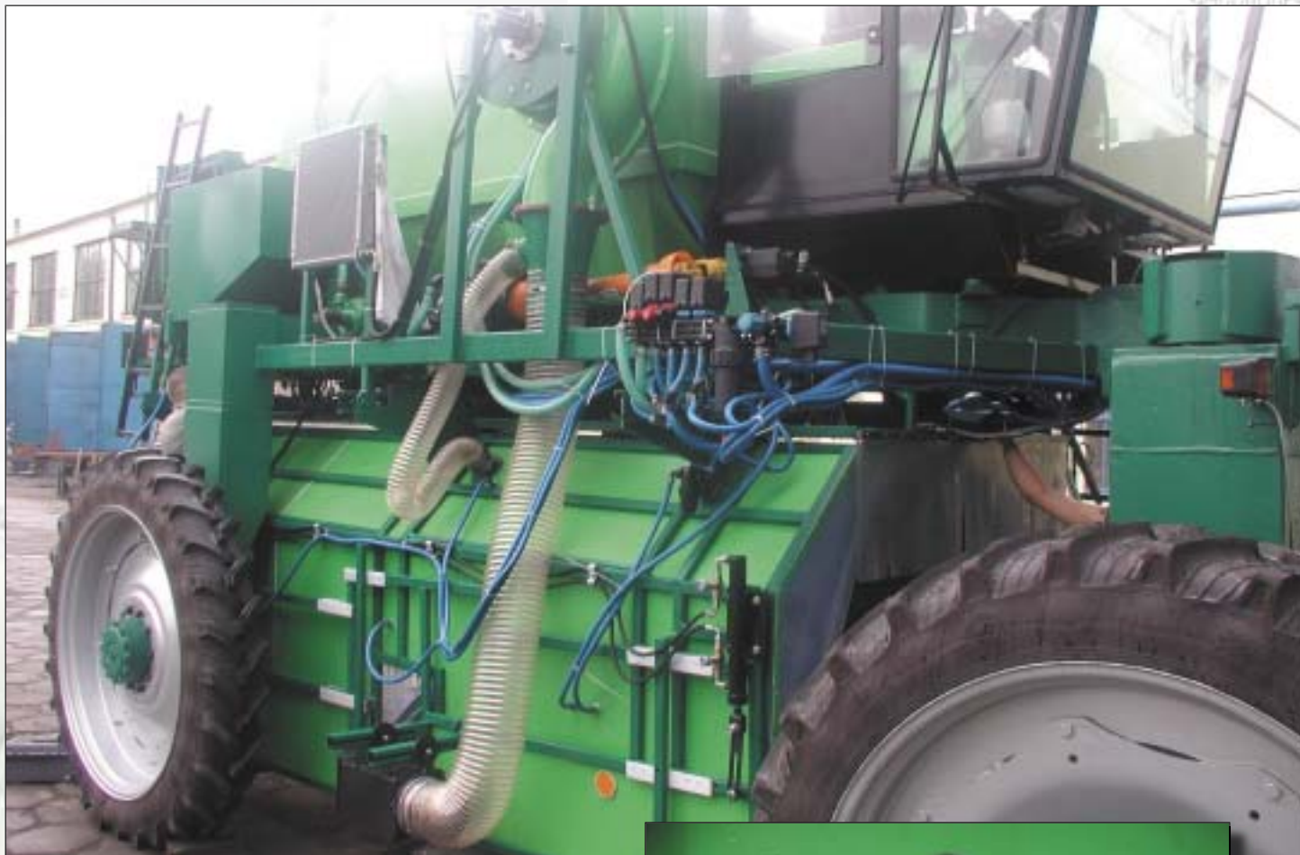
Na zdjęciu widoczny fragment kabiny i blok zaworów elektromagnetycznych.
