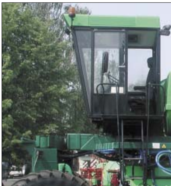
Dla poprawy warunków pracy operatora przewidziano kabinę z ogrzewaniem i klimatyzacją. Widoczne resorowanie fotela operatora (powyżej).
