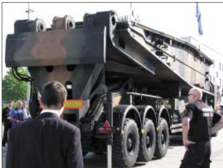
Widok ogólny nożycowego mostu samochodowego na podwoziu kołowym MS-20 „Daglezja”
