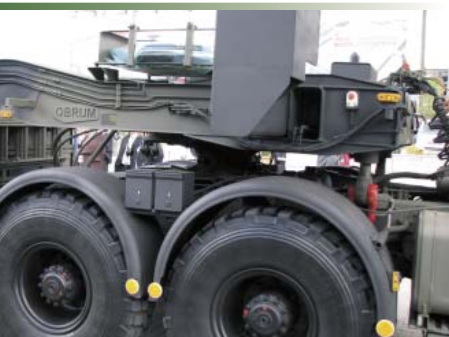
Sprzęg ciągnika i naczepty. Widoczne elementy tworzące siodło przęsła.
