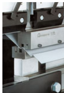
Z-Abkantungen: einstellbares System für Z-Abkantungen in Höhe von 1 bis 10 mm; kompletter Werkzeugsatz einschließlich Einstellwerkzeugen.
