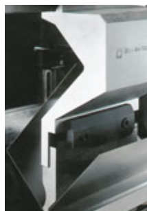
Geißfußverlängerung: Halter für das Abkanten von hohen U-Profilen, ausgelegt für die Aufnahme von Stempeln aus dem Serienprogramm.
