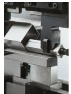
Werkzeugsatz für geschlossene Profile: Der Profilstempel mit 90°- und 88°-Stempelwinkel lässt sich problemlos aus dem fertig gekanteten 4-Kant-Profil herausziehen.
