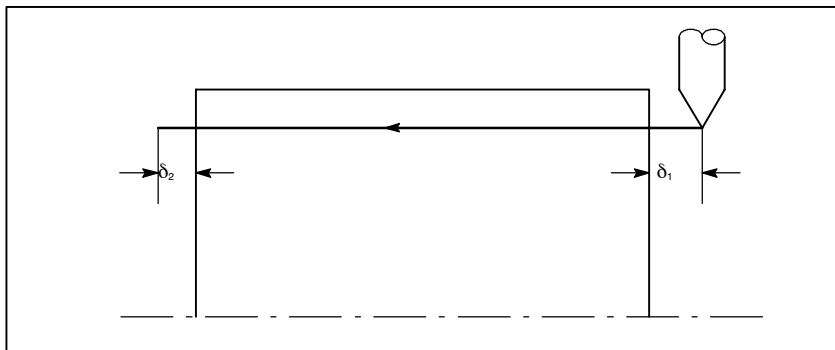
Rys. D.2 (a) Nieprawidłowo nagwintowany odcinek
