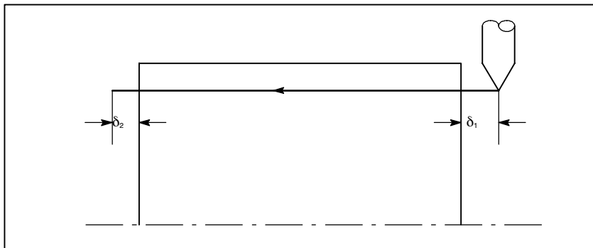
Rys. D.1 (a) Niewłaściwe położenie gwintu
