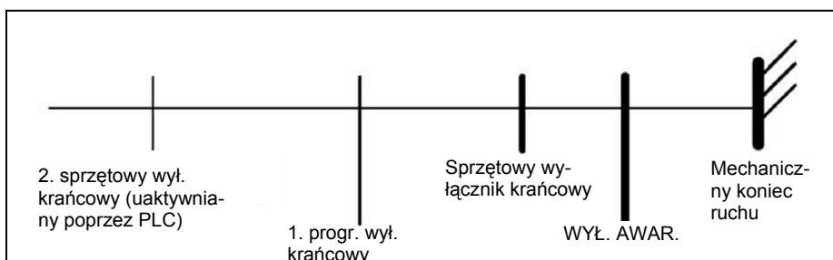
Rysunek 1-1 Ograniczenia końcowe na przykładzie dodatniego kierunku osi
